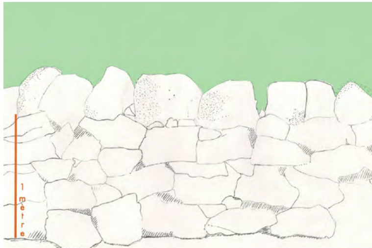
Figure 13: Dessin d'une portion de la maçonnerie au Grand Pas de Pontraute, côté extérieur à la forêt. On y remarque les disjointures et le couronnement très caractéristique du mur.
