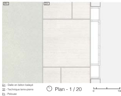
D1 - Dalle en béton balayé IP - Technique terre-pierre E1 - Pelouse Plan - 1 / 20 0 10m
