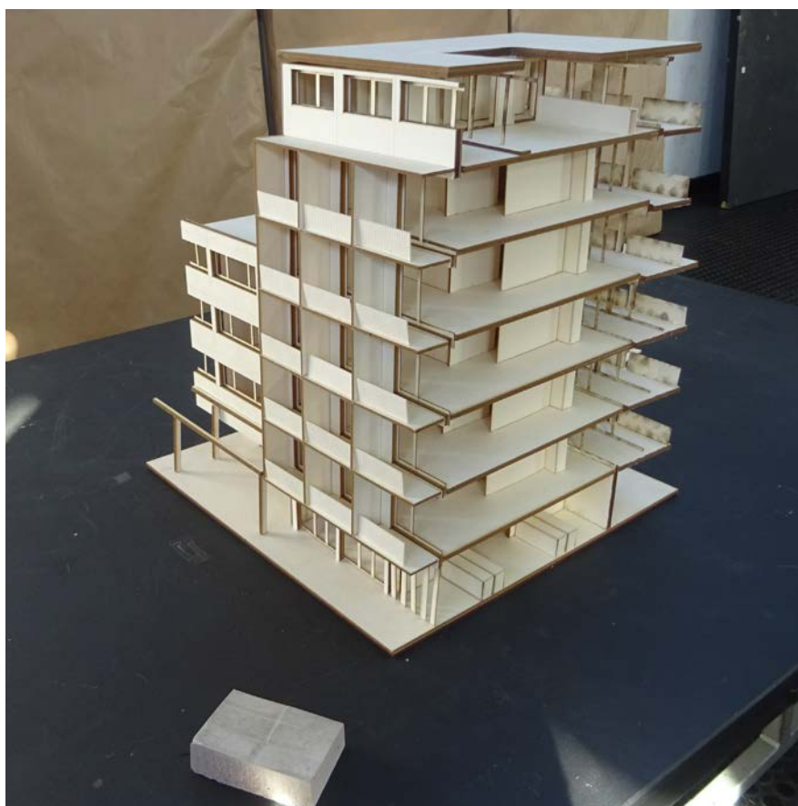
Coupe-maquette présentant la surélévation et le volume appliqué sur la façade. Echantillon de moulage des carreaux de terre cuite émaillée existants pour une proposition de parement sur ITE.
