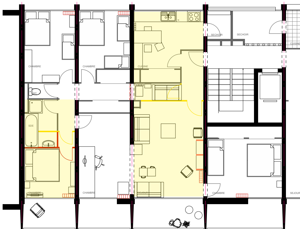
Transformations dans les travées nuit et jour dans un logement à structure transversale (Ancely)
