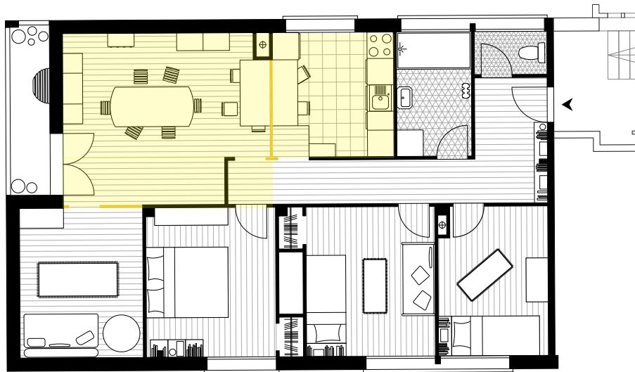
Réunion du séjour et de la cuisine dans un logement à structure longitudinale (Belle Paule)
