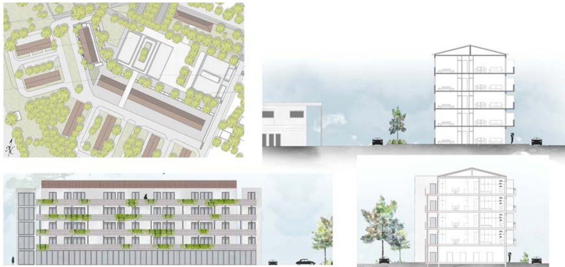
Figure 6.c : Mélanie Pierré – Interruption de la barre en trois parties – adjonction d'une épaisseur de coursives Coté nord avec distribution par des cages d'escalier aux extrémités. Organisation de certains appartements en duplex avec réutilisation des anciens escaliers.
