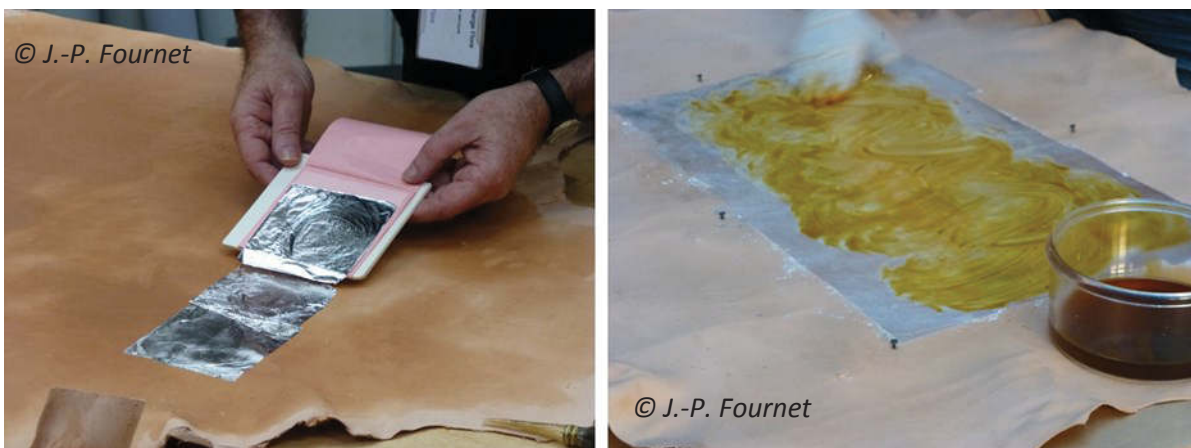
Figure 2. Fabrication de cuirs dorés modèles avec dépose des feuilles d’argent sur le cuir encollé (gauche) et recouvrement à la main de la surface par du vernis jaune (droite). © J.-P. Fournet 2014.
