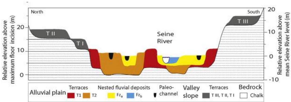
Figure 1. Schéma montrant la géométrie des nappes alluviales dans plaine alluviale de la Bassée (Deleplanque *et al.*, 2018). Les nappes T1 et T2 sont majoritairement constituées de graviers et de sables, actuellement exploitées. En revanche, les paléo-chenaux, constituent des entités dont le remplissage est plus hétérolithique et qui reste moins bien connu.
