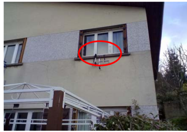
Figure 7 : Sonomètre situé en façade à l'extérieur de la chambre à coucher et sonomètre situé à l'intérieur de la chambre
