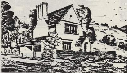
p. 54 Maison du garde-chasse, sur la même propriété du GRIZEDALE, construite par les mêmes architectes. Maçonnerie en moellons du pays recouverte de crépi gris.
