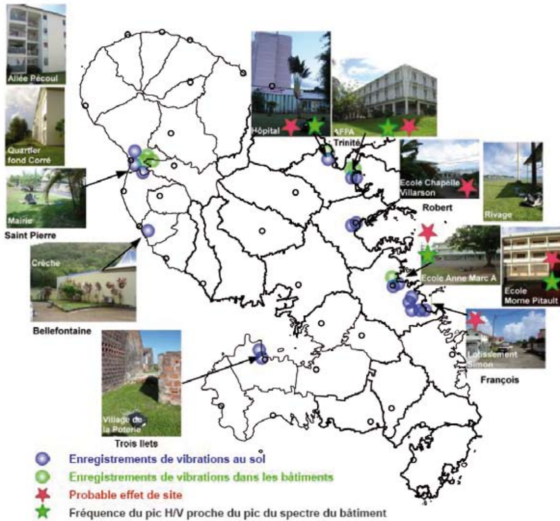
Fig. VI-2 : Synthèse de la localisation et de l'interprétation des enregistrements de vibrations ambiantes. (doc. CETE)
