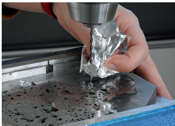
Fig. 40 : Forage du métal pour prélèvement radiocarbone et récupération des copeaux destinés à la datation
