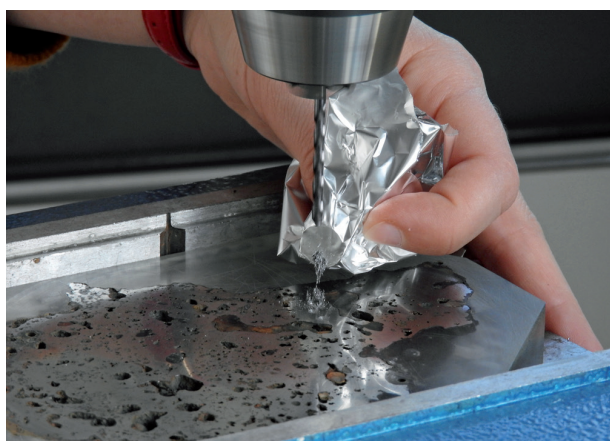
Fig. 40 : Forage du métal pour prélèvement radiocarbone et récupération des copeaux destinés à la datation
