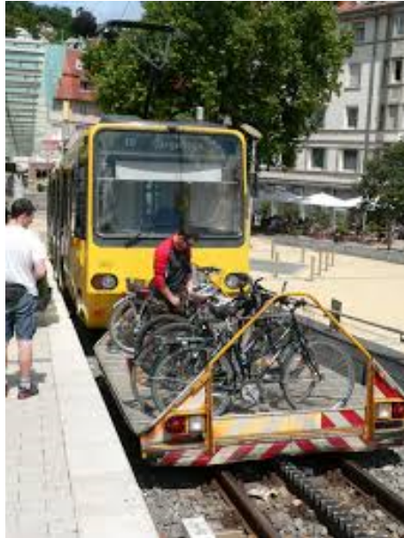
Figure 15 : Transport de vélo par tramway à crémaillère à Stuttgart
