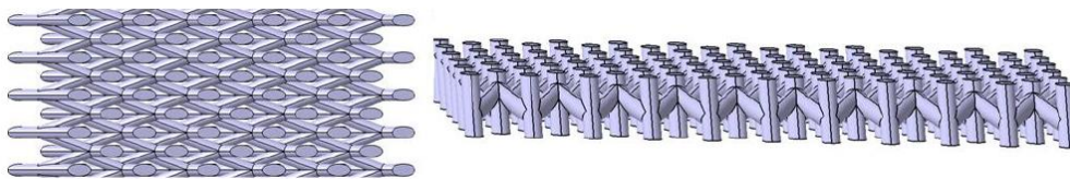
Fig. 3 : Géométrie de canaux 3D avec des interconnexions entre les trous de refroidissement.
