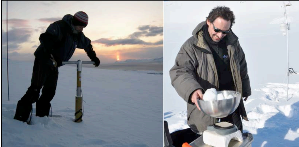
Figure 9 – Carottage au drill Pico (à gauche) et pesée in situ des carottes de neige (à droite)
