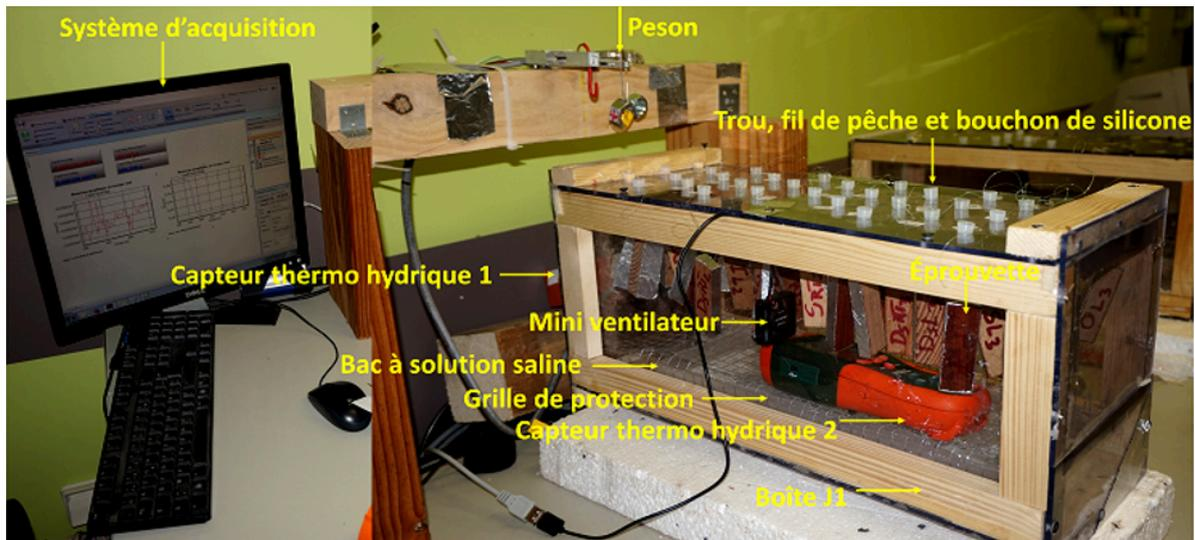
Fig. 3 : Dispositif expérimental
