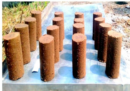
Fig. 2 : Echantillons de briquelettes
