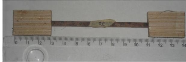
Fig. 1 : Photo d'une éprouvette de la coque
