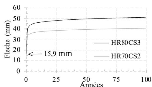
Fig. 4 : Flèche maximale de la nervure
