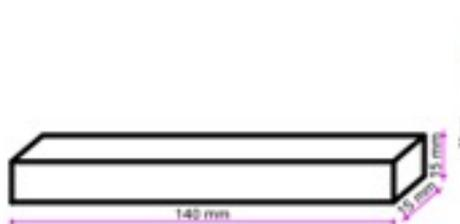
Fig.1 : Eprouvettes de flexion
