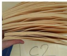
Fig. 2 : exemple de bois ondulé
