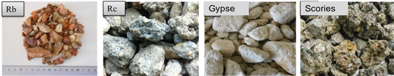
Figure 1. Exemple de composantes triées visuellement à la main dans les sols urbains. Rb : déchets de type brique, tuile... et Rc : déchet de démolition à base de béton.
