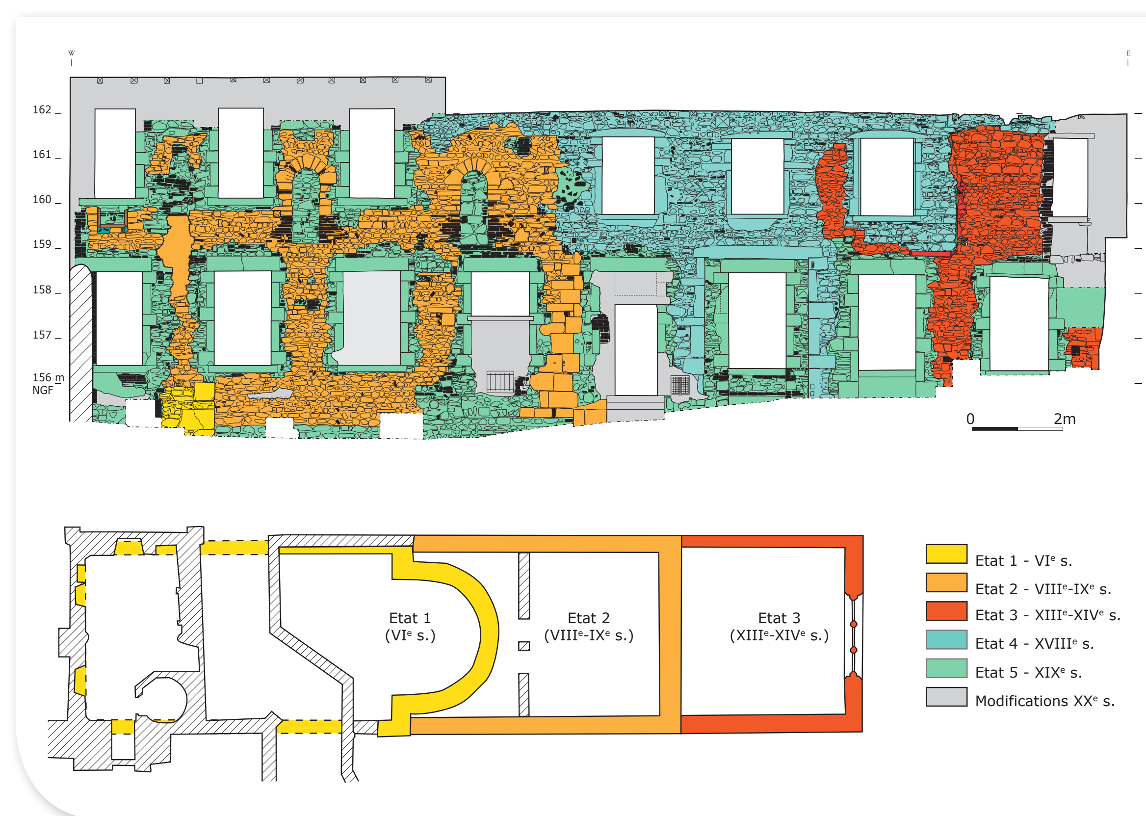
Fig. 1 Relevé phasé du mur gouttereau Sud : Quentin ROCHET & Camille COLLOMB
