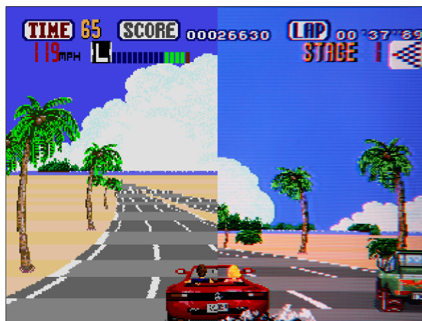
Figure 1. Rendu simple avec un émulateur à gauche et rendu d'une télévision à droite (jeu Out Run ).
