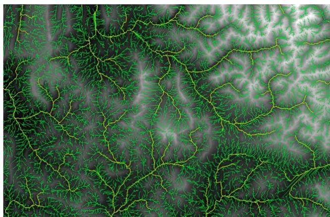
**Figure 4.35.** Comparaison des réseaux extraits avec un seuil de 5 (vert) et 8 (jaune)
