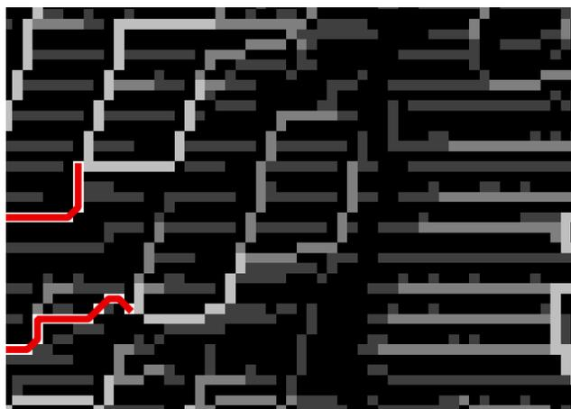
**Figure 4.34.** Zoom sur deux débuts de rivières (en rouge). Le raster de fond est le raster d'ordination de Strahler pixel par pixel « srtm\_sp\_strahler\_utm31n.tif » (résolution du pixel : 30 mx30 m)
