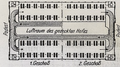
Zyklop-Garage, Bukarest. Einbahnrampen im gedeckten Lichthof, flankiert durch je ein Fahrstraßenelement. 1930.
