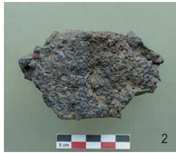
Scorie é coulée en plaque (ST 3-02) ; face inférieure
