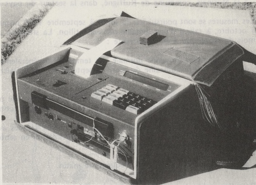
LA CENTRALE DE MESURES SCHLUMBERGER (30 VOIES)
