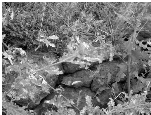
(b) coulée de Nizas, affleurements de blocs de basalte dégagés par une coupe. L'extraction des faciès d'altération de surface permet d'accéder à des blocs arrondis de gros modules.
