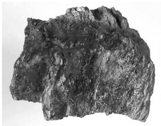
Fig. 5. Vues de dessus ( for the editor : haut ou gauche, largeur du fragment environ 5 cm) et en coupe après section ( for the editor : bas ou droite) du fragment de cloritischiste mis au jour sur le site du Vallon du Longet présentant une surface vitrifiée (en noir). L'étude de la microstructure de la zone vitrifiée montre qu'il s'agit très certainement d'une paroi de structure de combustion liée à la transformation pyrométallurgique du minerai de cuivre (photos Yvan Coquinot, C2RMF).
