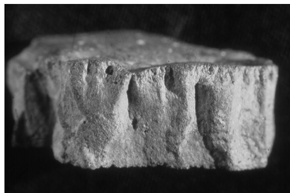
Fig. 7. Vue sur la tranche d'un fragment de scorie de Saint-Véran montrant, sur la surface de fracture, la couche de morphologie prismatique qui occupe les 1-2 premiers millimètres sous la surface supérieure (en haut). L'épaisseur totale de la scorie est de l'ordre de 10 mm.
