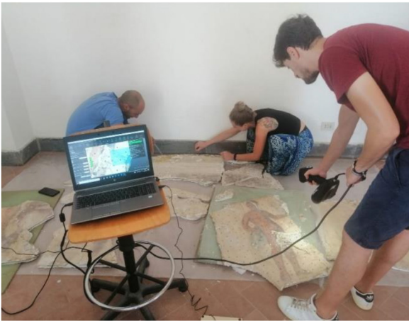
Fig. 22. Scansione con tecnologia laser 3D
