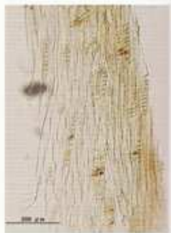
Pl. 82. – Piédestal du dieu roi gardien n° 11b, coupe tangentielle, x 75, Chamaecyparis obtusa Endlicher.
