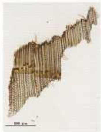
Pl. 70. – Piédestal du dieu roi gardien n° 11b, coupe transversale, x 30, Chamaecyparis obtusa Endlicher.
