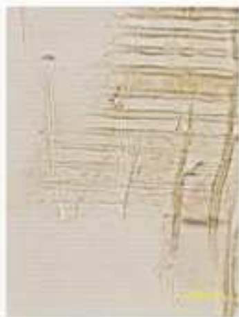
Pl. 71. – Piédestal du dieu roi gardien n° 11b, coupe radiale, x 310, Chamaecyparis obtusa Endlicher.
