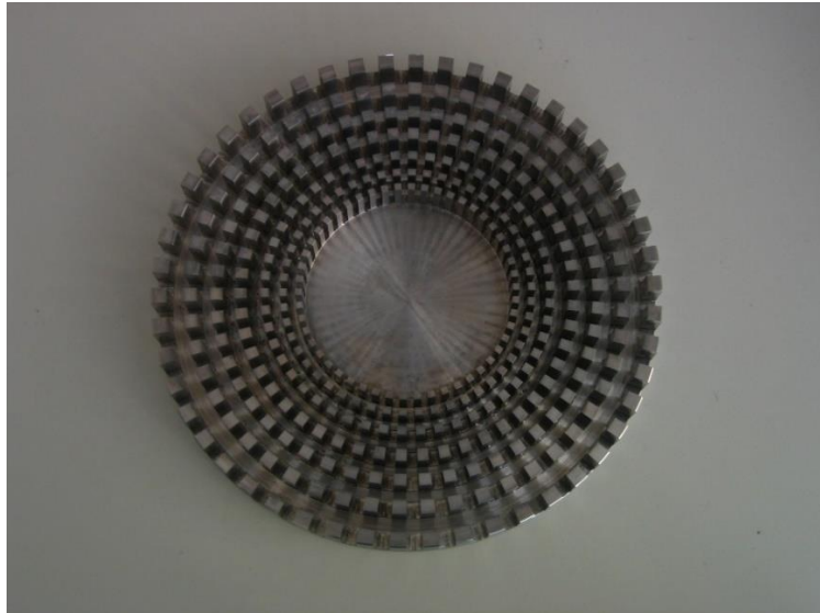
Figure 1 : Photographie de la cape d'invisibilité pour les vagues en vue de dessus ; Ce métamatériau de 20 centimètres de diamètre est constitué de 7 rangées concentriques de petits pylônes de 1 centimètre de haut. Quand les vagues pénètrent dans la cape, elles privilégient un trajet contournant la zone au centre du dispositif qui est donc protégée des vagues. (crédit photo : Photothèque CNRS, Institut Fresnel).
