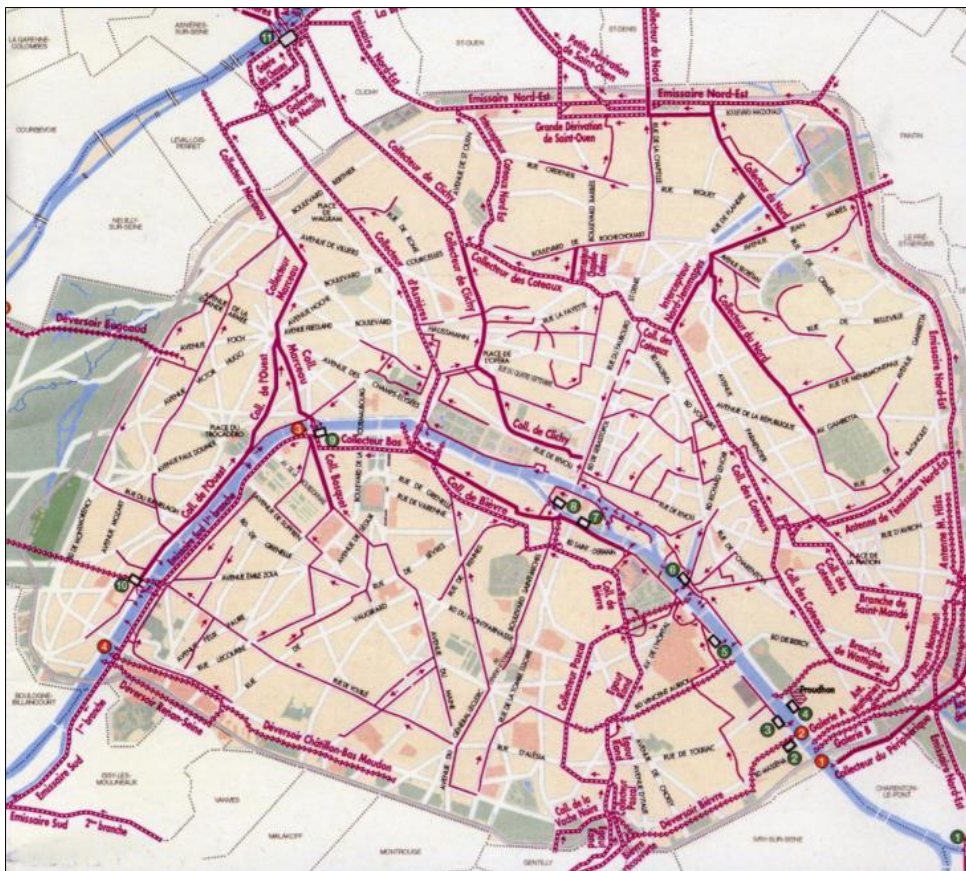
Figure 10 Carte du réseau d’assainissement parisien. Les flèches représentent les collecteurs drainant les déversoirs d’orage et souvent assimilés au réseau pluvial.
