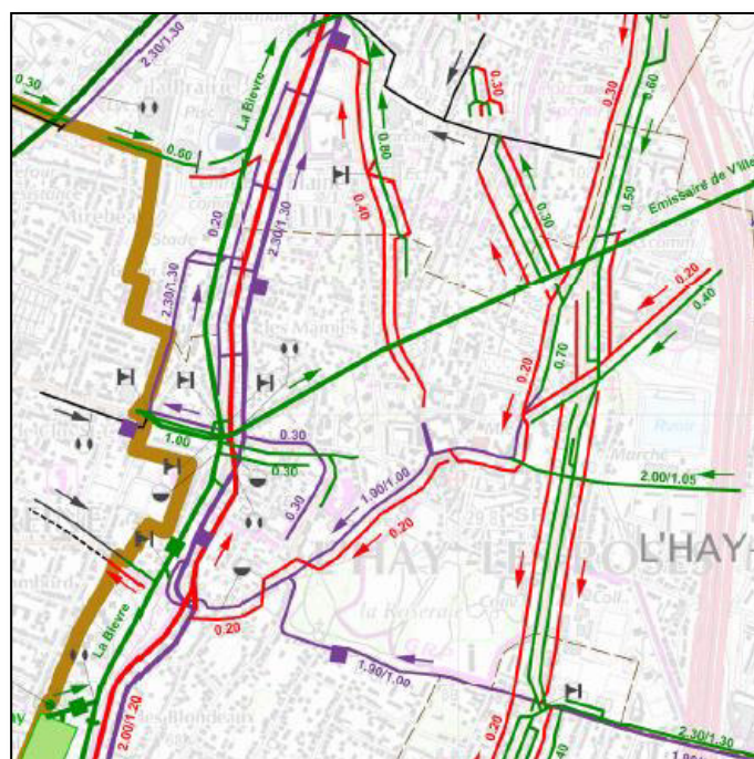
Figure 3 : Réseaux unitaire (violet), pluvial (vert) et d’eaux usées (rouge) en parallèle.(DSEA94, 2013)
