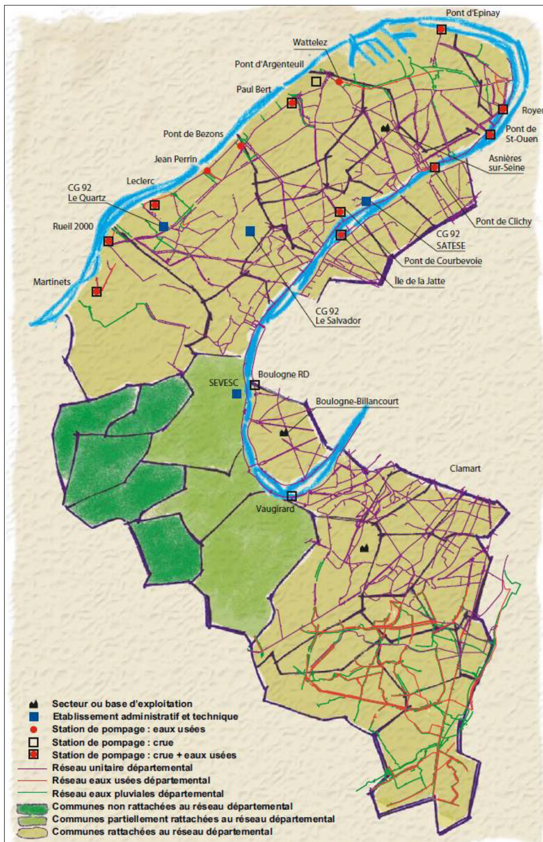
Figure 14 : Carte du réseau d’assainissement des Hauts-de-Seine. En mauve : le réseau unitaire, en rouge : le réseau d’eaux usées et en vert le réseau d’eaux pluviales (CG92, 2006)
