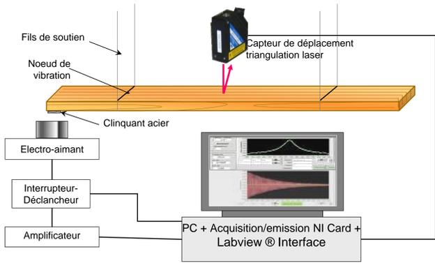
Schéma de principe du dispositif Vybris
