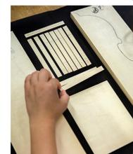
Echantillonnage pour anisotropie Longitudinal / Radial
