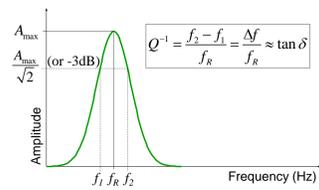
Détermination dans le domaine fréquentiel
