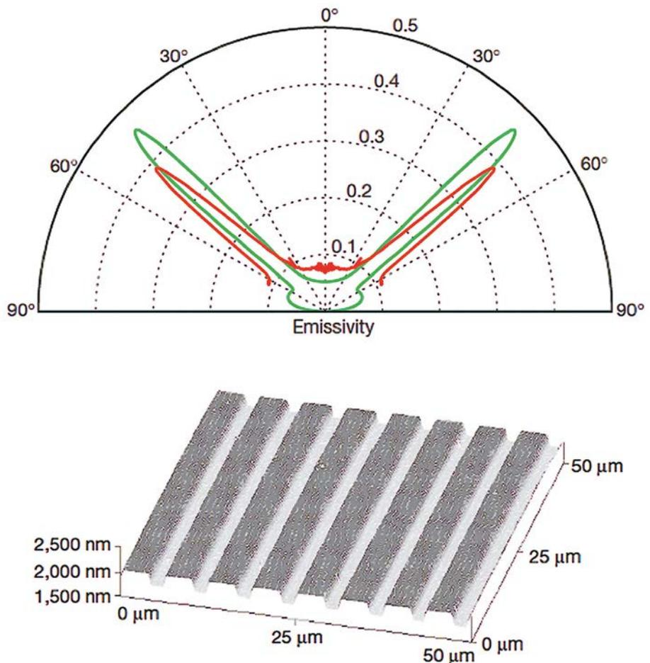
On peut également concevoir des réseaux ou des métasurfaces résonantes présentant des résonances d'absorption très étroites angulairement ou spectralement ce qui conduit donc à de l'émission de rayonnement thermique très directionnelle (spatialement cohérente, ou très monochromatique (temporellement cohérente))
