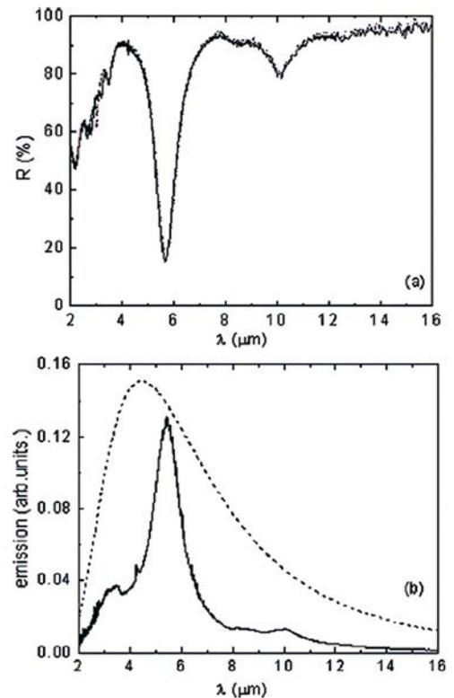
**Figure 2.** Métasurface composée d'un miroir d'aluminium recouvert de résonateurs plasmoniques présentant un pic d'absorption, (a) : réflectivité, (b) : spectre d'émission. Figure adaptée de [6] avec permission de AIP Publishing.
