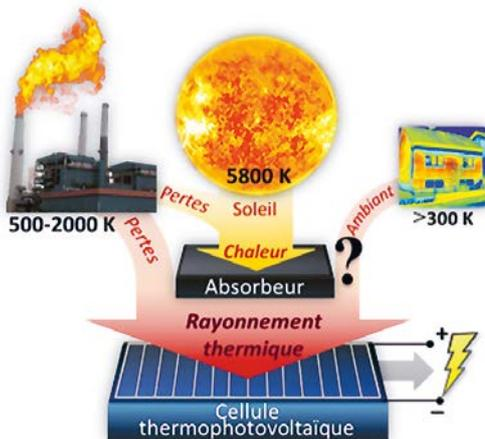
Les cellules solaires permettent de convertir le rayonnement du soleil en puissance électrique, mais le rayonnement thermique issu des corps chauds est une autre source d'énergie omniprésente dans le milieu ambiant qui peut être mise à profit. Les cellules dites thermophotovoltaïques convertissent en électricité ce rayonnement dans la gamme infrarouge avec des rendements attendus élevés.
