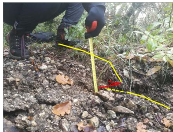
Figure CG5 : Deux exemples d'indices de ruptures de surface associés au seisme du Teil du 11-11-2019 cartographiés par l'équipe tectonique active (J-F Ritz, S. Baize, M. Ferry, C. Larroque et L. Audin): [en haut] plis et fissures en échelons affectant la route (ph. J-F Ritz) ; [en bas à gauche] : détails de l'indice présenté en haut, montrant le plissement de la chaussée et son soulèvement dans la partie SE coté boussole (ph. J-F Ritz) ; [en bas à droite] : chemin de terre recoupé par la rupture avec soulèvement de la partie SE où se trouve la personne (ph. S. Baize).
