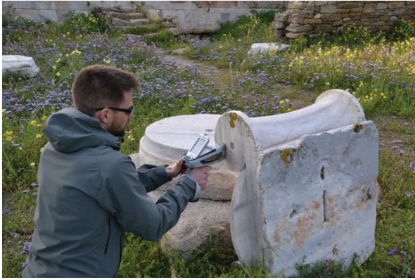
Mesure avec un spectromètre de fluorescence X portable sur un chapiteau ionique (photo : EFA, J.-Ch. Moretti).
