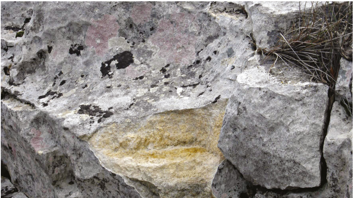
Fig. 15 : La pierre de Calissanne : le grain de la pierre, son homogénéité et sa finesse (cliché M. Vacca-Goutoulli)
