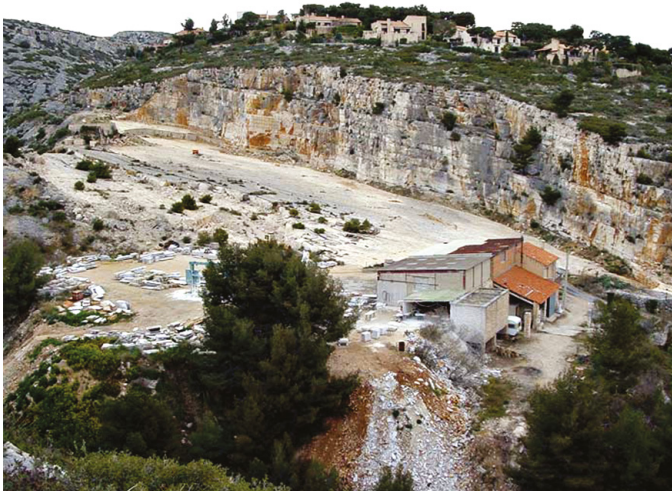
Fig. 18 : Dernière exploitation de la pierre de Cassis, le Bestouan. Puissance de relative importance des bancs exploités dernièrement. La carrière a cessé son activité en 2013 (cliché Lakko, Marseille)
