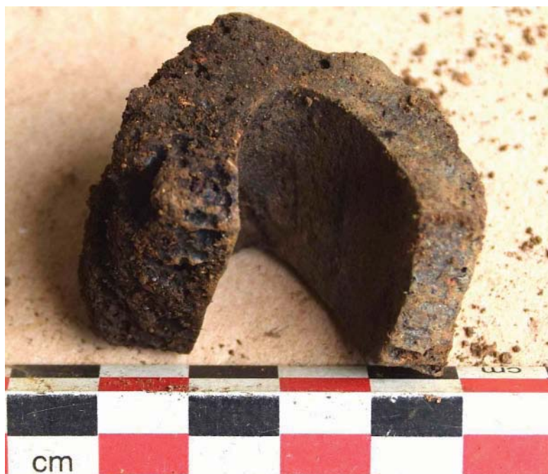
Figure 49 : Scorie présentant le négatif probable d'une tuyère
