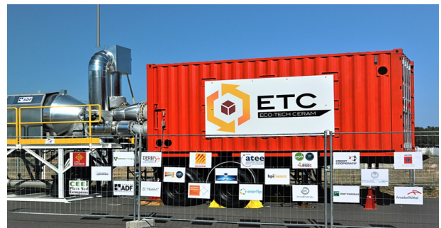
Fig. 1. EcoStock ® de 4 MWh th ( D = 2m et L = 4m ).
