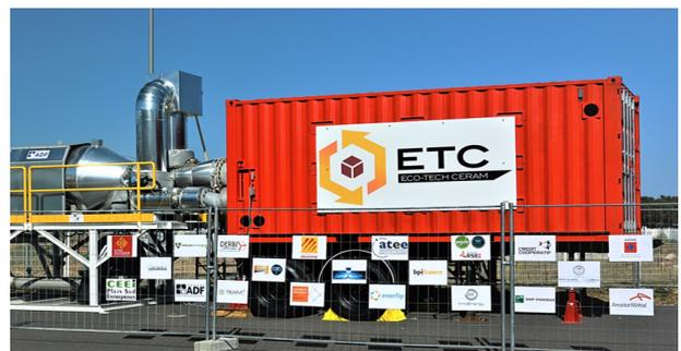
Fig. 1. EcoStock<sup>®</sup> de 4 MWh<sub>th</sub> ( $D = 2m$  et  $L = 4m$ ).
