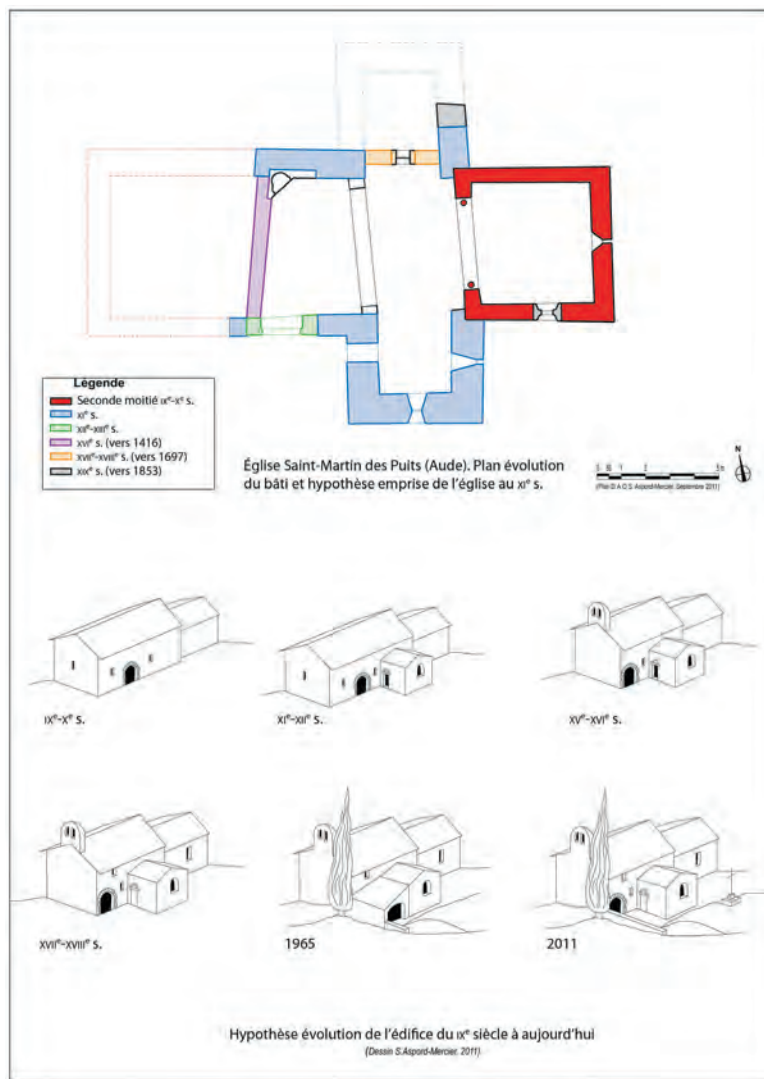
Fig. 1 : Église de Saint-Martin-des-Puits : évolution de la construction. Plan et schémas. Droits de reproduction : S. Asporod-Mercier.
