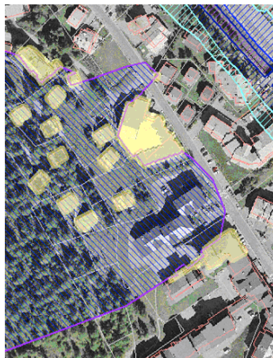
Fig. 11.5 Identification des bâtiments menacés par un couloir d'avalanche à partir d'une orthophoto
