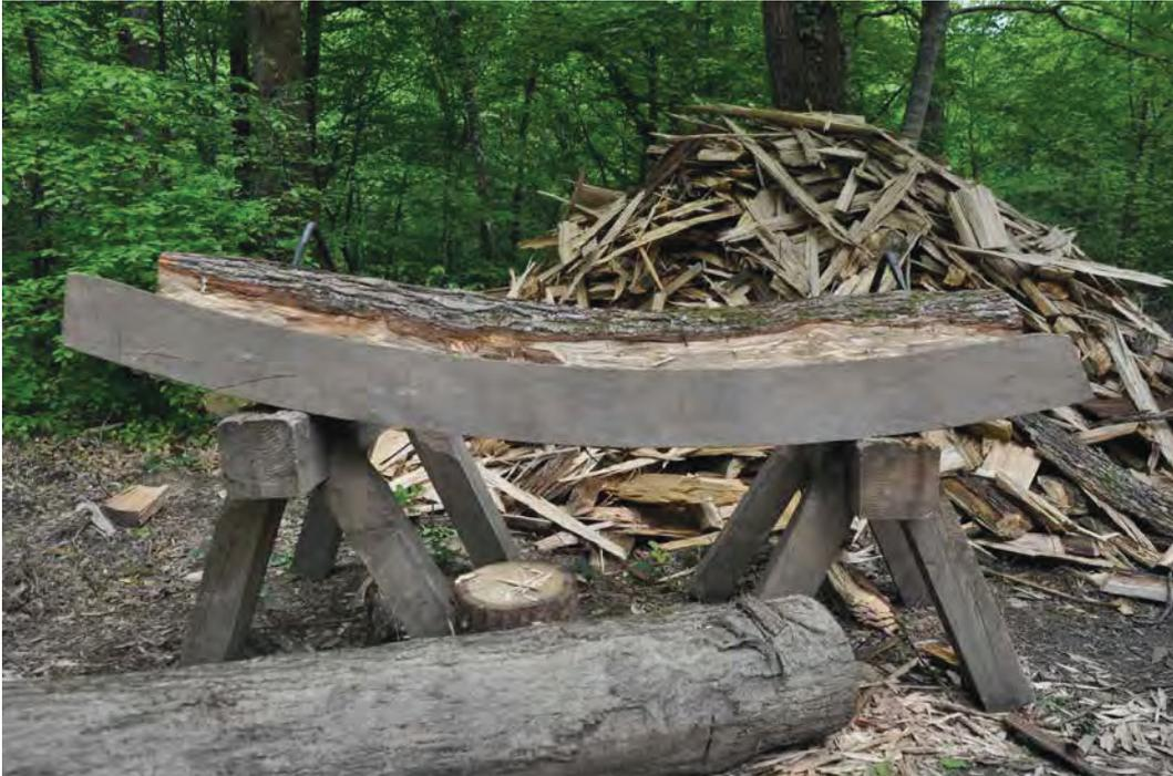
Fig. 5 – Utilisation d'un gabarit définissant le tracé pour l'équarrissage d'une pièce courbe (cliché F. Épaud).
