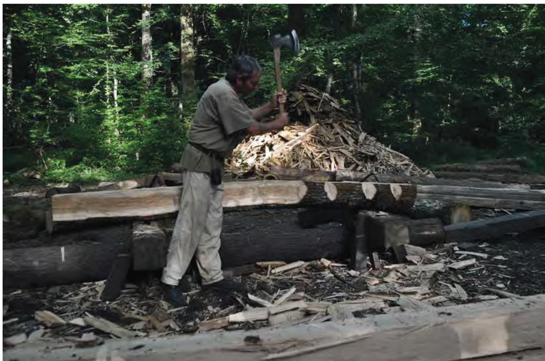
Fig. 4 – Equarrissage à la doloire suivant les encoches d'ébauchage (cliché F. Épaud).
