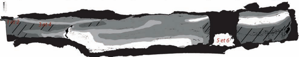
Fig : Schéma interprétatif de la distribution de la teneur en carbone au sein de la section métallographique 1 après polissage et attaque Nital
