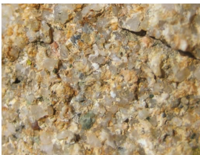
Grès GSM 118 dans lequel dominent les éléments gris translucides de quartz liés par un ciment carbonaté blanchâtre à beige (zoom sur Photo Canon).
