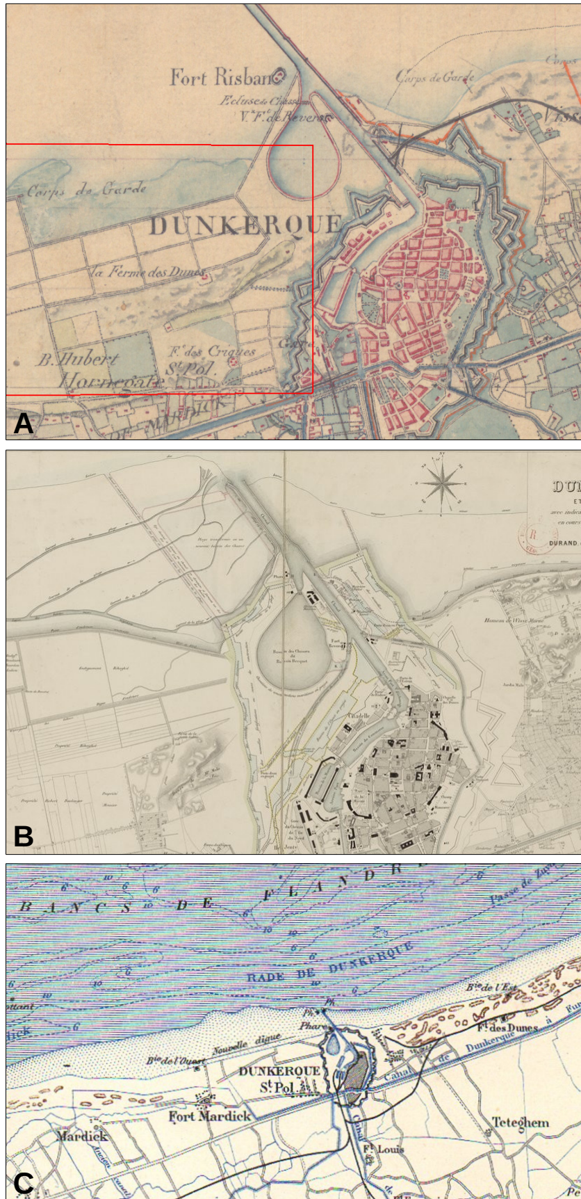
Figure 6.43 : Système de digues et de fossés présent à Dunkerque (A) en 1825 (encadré en rouge) et (B) en 1870 ; (C) « Nouvelle digue » à l'ouest du chenal en 1880 à Dunkerque (extraits de cartes de (A) IGN, 1825 ; (B) Durand, 1870 ; (C) Marga, 1880)
