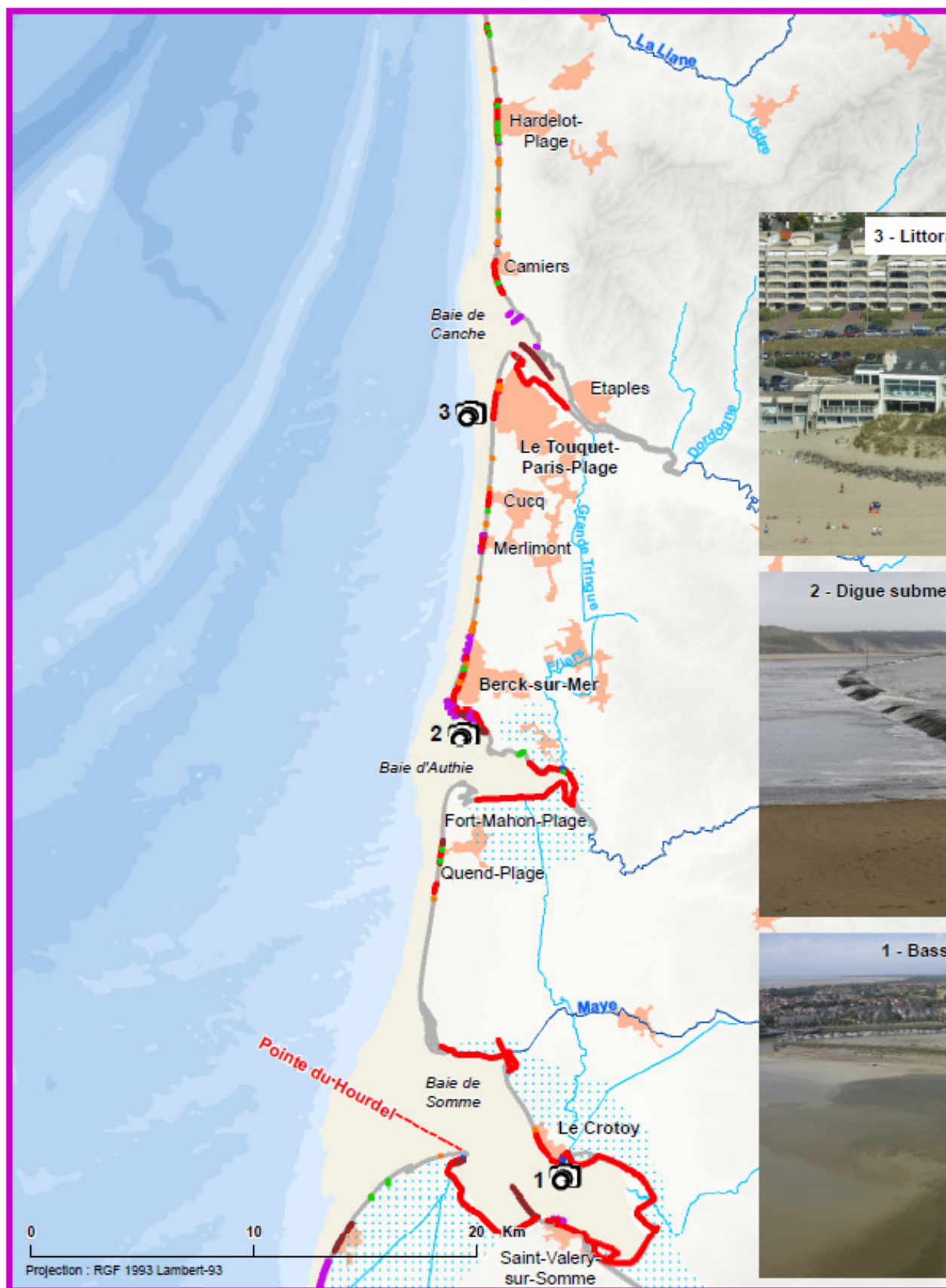
Figure 5.2 : Ouvrages et aménagements côtiers actuels de la plaine maritime picarde
