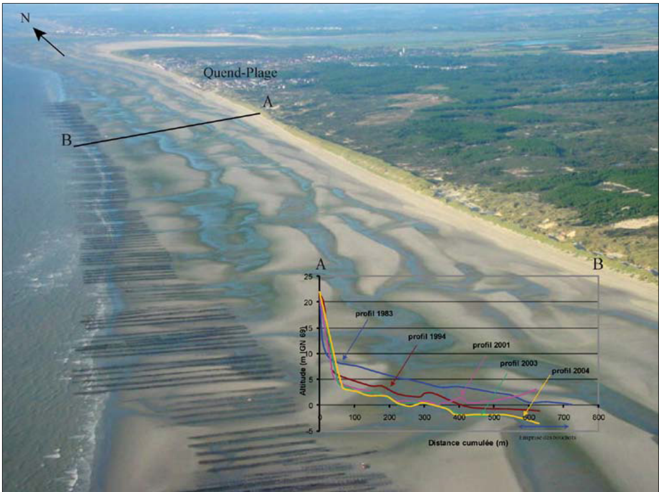
Figure 5.64 : Alignement des pieux de bouchots parallèles à la côte sur 5 km entre Quend-Plage et la pointe de Saint-Quentin et graphique comparatif de profils relevés à des dates différentes dans la zone nord des bouchots (Bastide, 2011)
