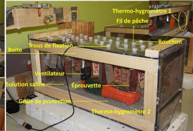
O= Okoumé; P= Padouk; L= Iroko; S= Sapin ; D= Douglas; 1=Épaisseur de (20 mm); 2=Épaisseur de (10 mm); 3=Épaisseur de (5 mm) sens longitudinal (L) et transverse (RT)
