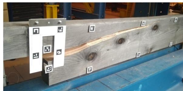
Fig. 7 : Rupture de la poutre
