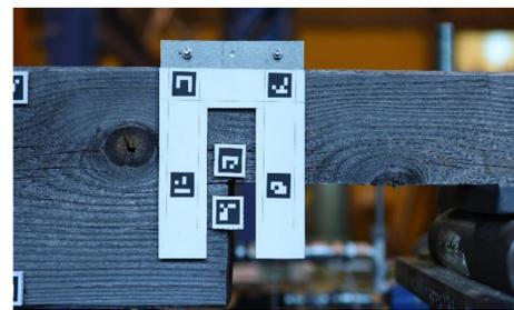
Fig. 5 : Mesure de l'ouverture de fissure
