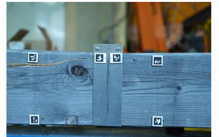
Fig. 6 : Mesure de la longueur et la hauteur de fissure
